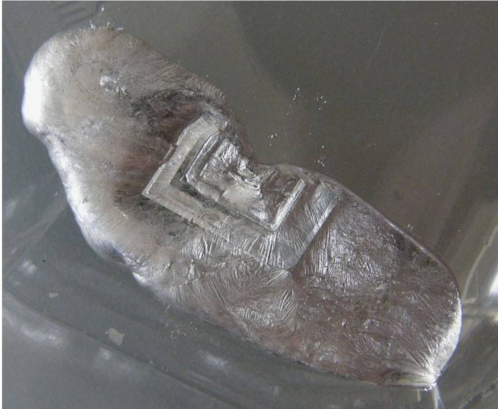
شکل ۳ تبلور گالیوم از مذاب خود
