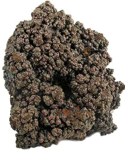
شکل ۱. لیمونیت، از سنگ‌های متداول معدنی حاوی نیکل
