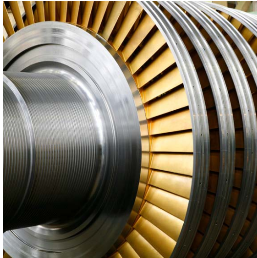
شکل ۵ کاربرد آلیاژ کبالت در دیسک توربین
