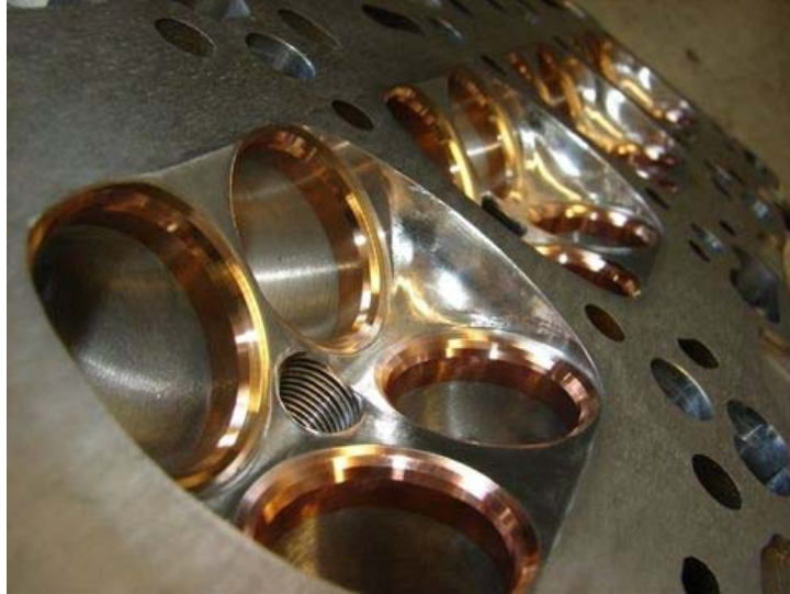
شکل ۸ سیتهای بریلیوم-مس برای سوپاپها در موتورهای خودورهای مسابقه
