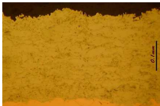
شکل ۱۹- میکروساختار پوشش دهی سوپرآلیاژ نیکل-مولیبدن-کروم به روش اسپری حرارتی
