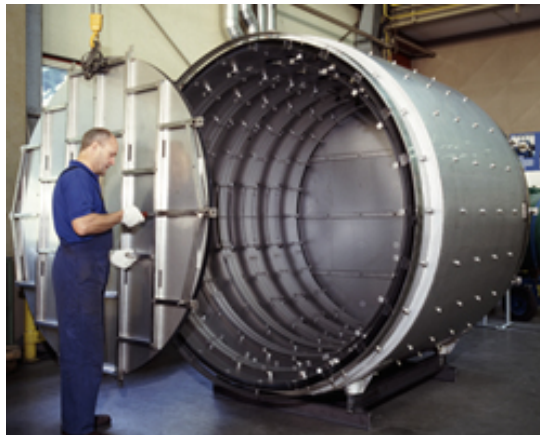
شکل ۶- استفاده از مولیبیدن در ساخت کوره‌های دما بالا و خلأ
