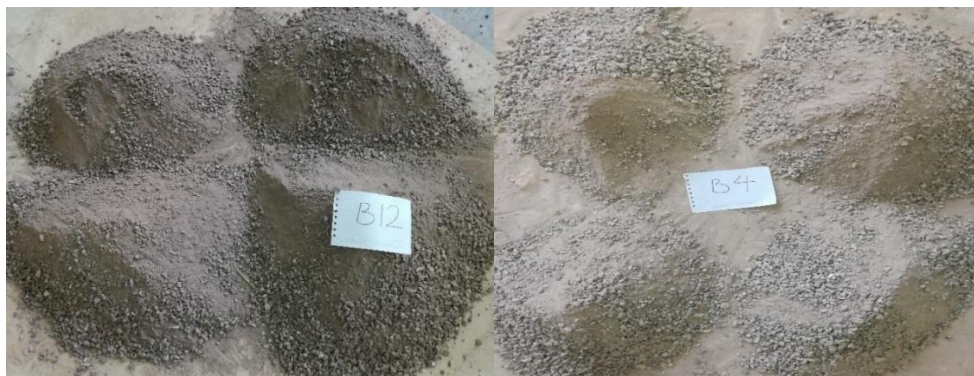
شکل ۲: تصویری از مراحل تقسیم نمونه‌های خرد شده تا ابعاد ریزتر از یک چهارم اینچ به روش مخروطی
