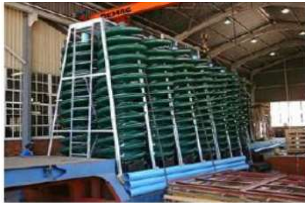
شکل ۷. اسپیرال SX7 طراحی و نصب توسط شرکت Multotec Process Equipment Ltd of Spartan
