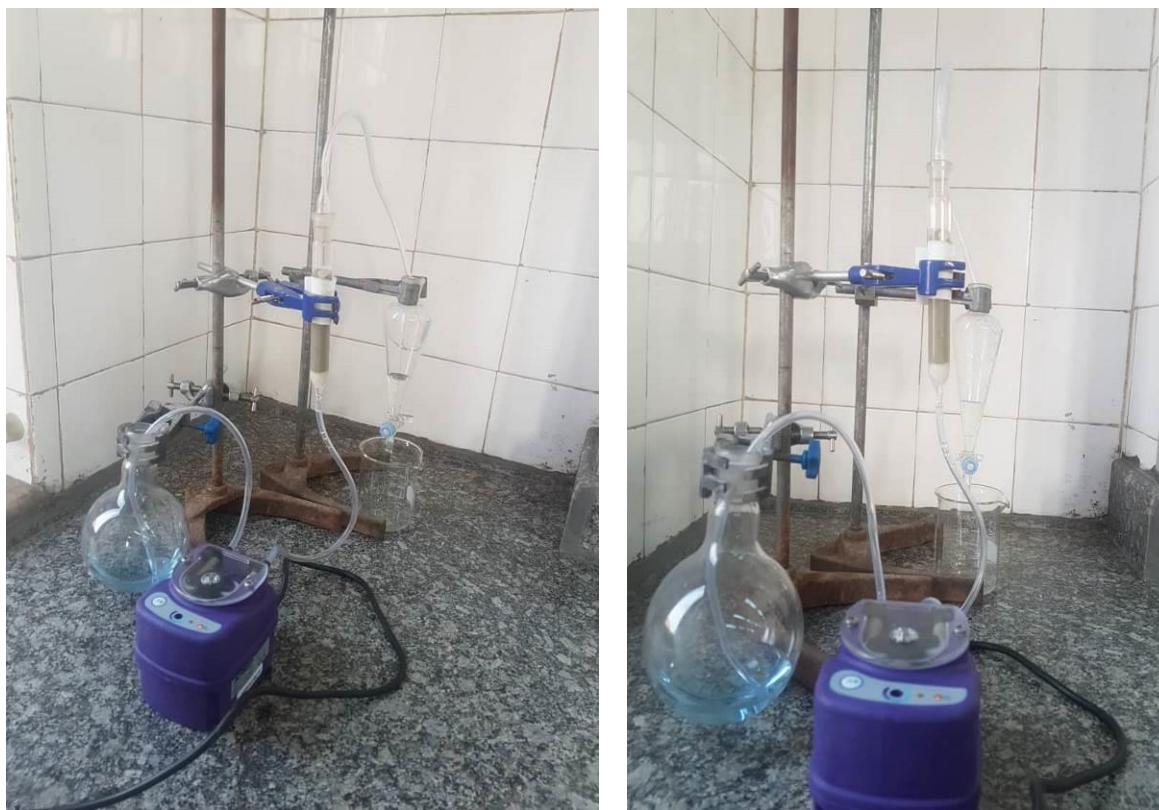
شکل 3 ستون با بستر ثابت مورد استفاده در این مطالعات
