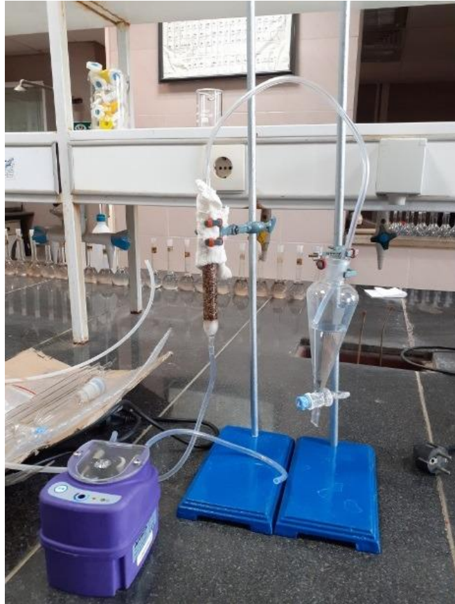
شکل 4. اجرای ستون آزمایشگاهی در مجتمه سرب و روی انگوران
