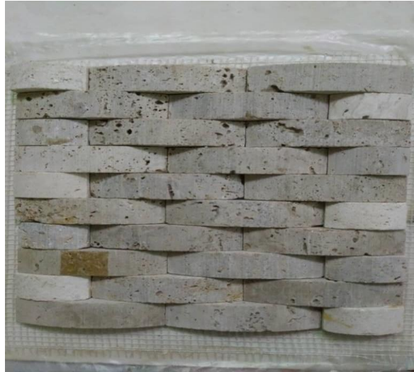
شکل ۷- طرح سنگ آنتیک طبیعی تولید شده در مقیاس آزمایشگاهی
