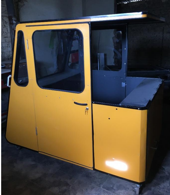
شکل ۱۷- ساخت کابین شبیه‌ساز دامپ‌تراک به صورت بومی
