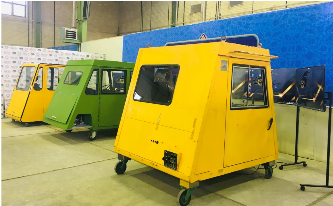
شکل ۱۸- طراحی و ساخت انواع شبیه‌سازهای دامپ‌تراک در ابعاد و مدل‌های مختلف
