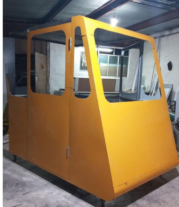
شکل ۱۷- ساخت کابین شبیه‌ساز دامپ‌تراک به صورت بومی
